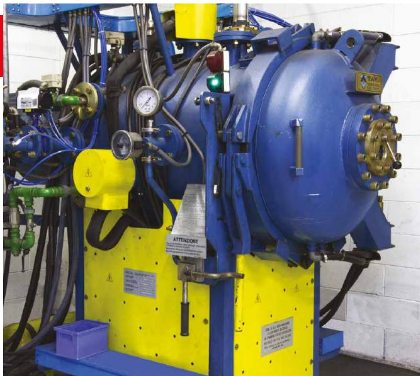
Forno di tempra sottovuoto per trattamento termico. Vacuum furnace for heat treatment. Installation de trempe Vacuum pour traitement thermique. Planta de templado Vacuum para tratamiento térmico.
