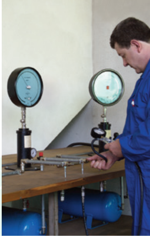
Banco prova per la verifica dei manometri Test bench to check gauges
